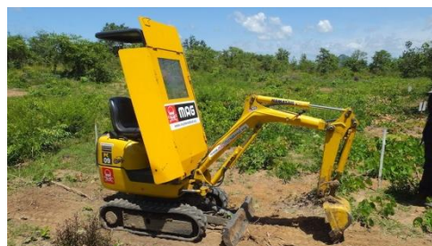
防護板が取り付けられた“タント”
